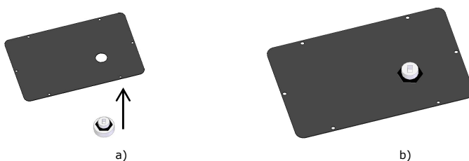
Figura 37 – Fixação do sensor de nível na peça
