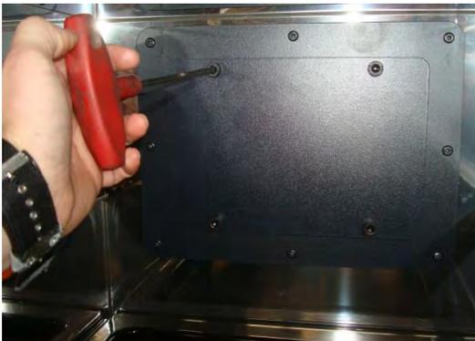
*Figura n°18 - Acceso a los tornillos para retirar la tapa de la escotilla*
